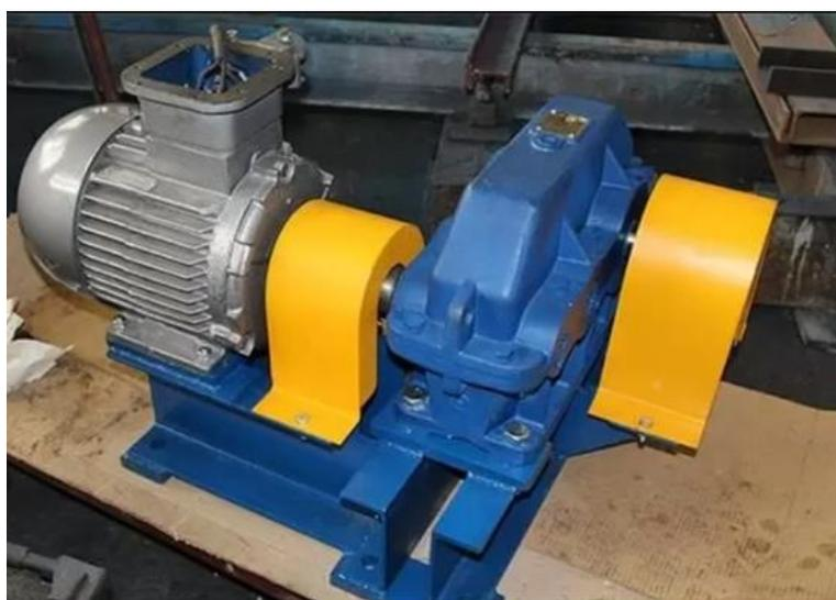
Рисунок 1.7 – Электрический привод ПЛ-1000
