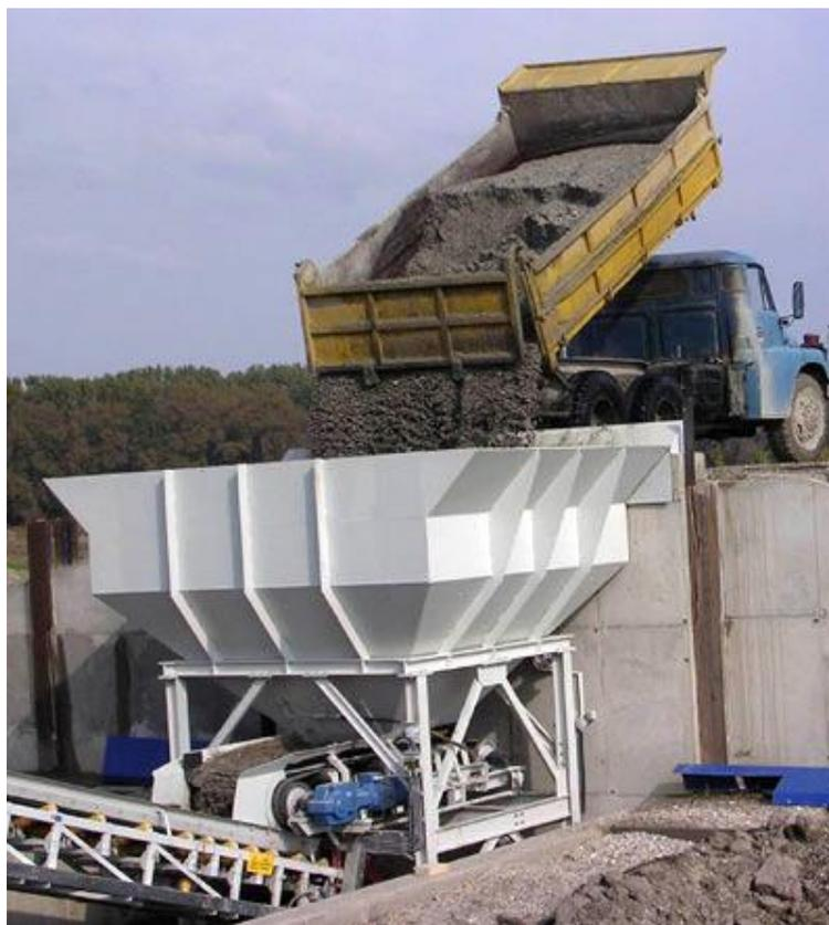
Рисунок 1.2 – Перемещение руды ленточным питателем PPV-1000
